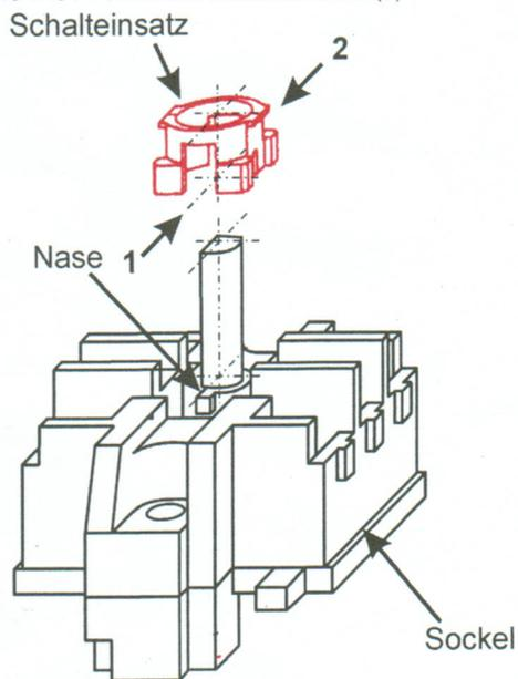
TAST-VERSION entsteht, wenn der Schalteinsatz mit der kleinen Aussparung (1) bis zum Anschlag über die "Nase" geschoben wird.
